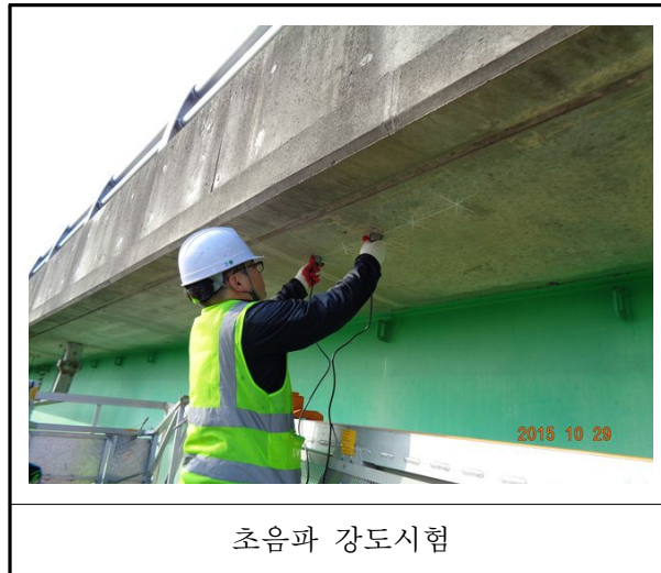
〈사진 3.19〉 초음파시험 측정 현황
